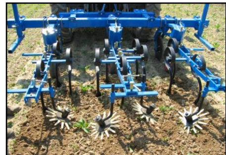
Photographie 2 : Bineuse à doigts Kress (Source : Chambre d'Agriculture 35)
